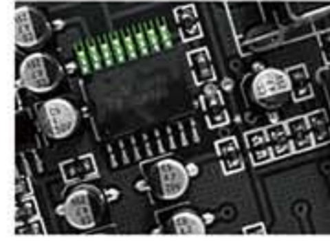
通过修正处理,可追踪工件的动向,移动检测范围的位置,正确进行检测。
